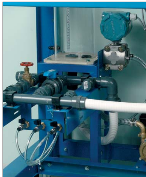
Ensemble vanne de réglage et régulateur PID
