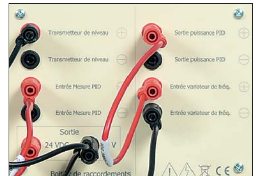
Boîtier regroupant les entrées et sorties des capteurs PID et commande variateur
