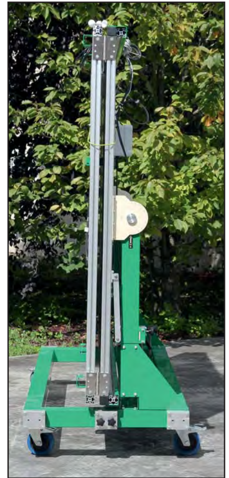
Position de transport sur roulettes. Une fois les panneaux extérieurs rabattus et les stabilisateurs retirés, dimensions : largeur 75cm, hauteur 195cm
